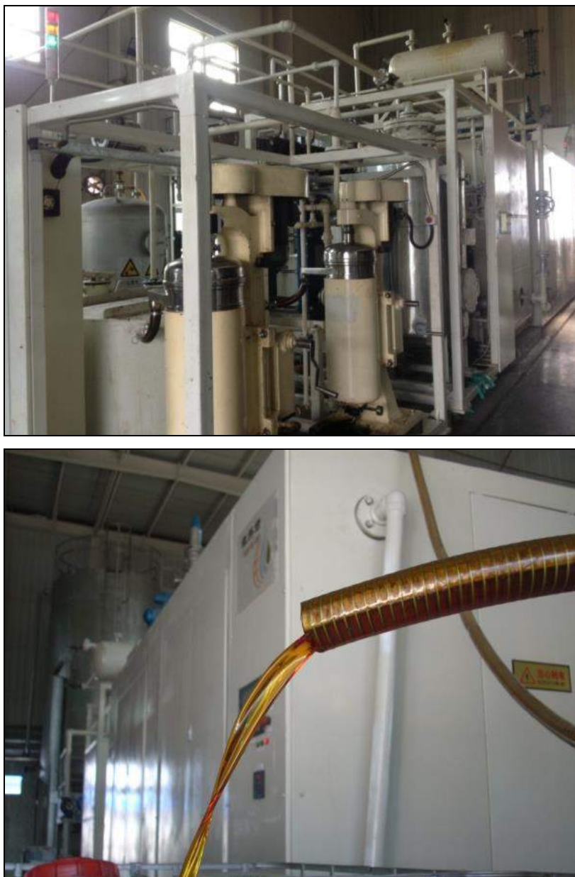
图 3.1-6 北京生态岛科技有限责任公司采用纳滤膜系统处理废油的生产状况
