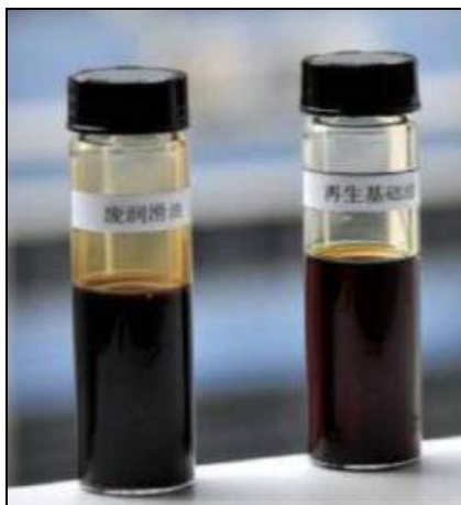
图 3.1-5 处理前后产品（左边为原料，右边为经过纳滤膜处理后的再生基础油）
